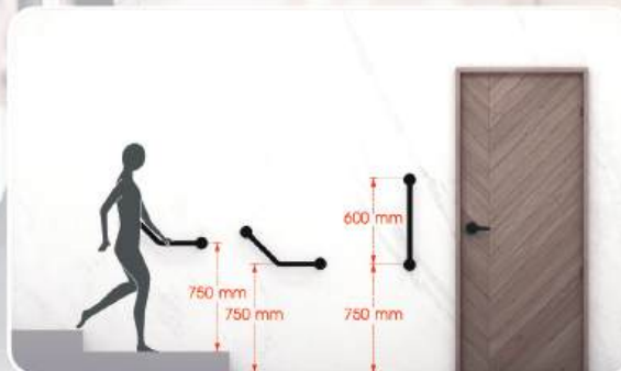
รูปแบบการติดตั้งบนพื้นที่ต่างระดับ และพื้นราบ
